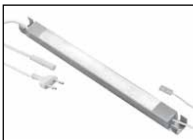
max. 20 Watt, primär: 100-240 Volt, 50/60 Hz sekundär: 24 Volt, inkl. 3.000 mm Netzkabel und 1.800 mm LED-Anschlußkabel, ohne Schalter (20 Watt sind geeignet für max. 3.450 mm unserer LED-Beleuchtung)
